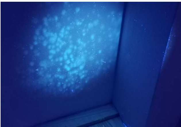
Abbildung 4 Erkennung von ungefärbtem Schimmelbefall durch Fluoreszenzbildanalyse mit UV-Anregung
