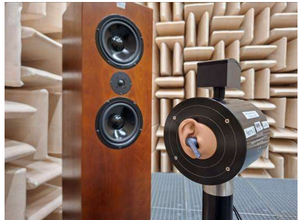
Abbildung 3: Beispiel eines Ohrstöpsels, der in einer ATF zur Prüfung der pegelabhängigen Dämmung gemäß EN 13819-3 eingesetzt ist
